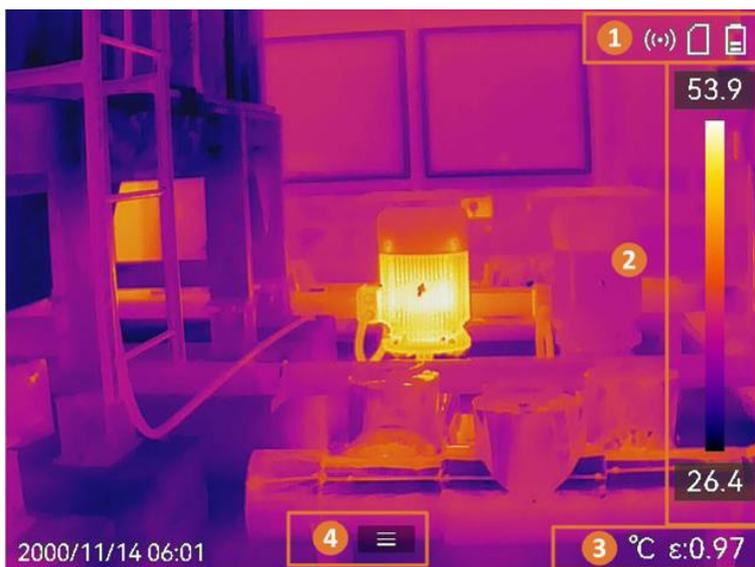
Figura 2-6 Interfaccia di visualizzazione live
