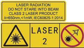
Avvertenza: La radiazione laser emessa dal dispositivo può causare lesioni agli occhi, ustioni alla pelle o combustione di sostanze infiammabili. Evitare l'esposizione diretta degli occhi al laser. Prima di attivare la luce supplementare verificare che non ci siano persone o sostanze infiammabili davanti all'obiettivo laser. La lunghezza d'onda è di 650 nm e la potenza è inferiore a 1 mW. Il laser rispetta le norme dello standard IEC60825-1:2014.
