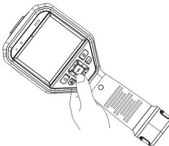
**Figura 2-5 Controlli tramite pulsanti**
