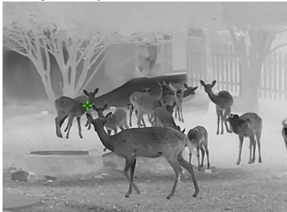
Rysunek 5-3 Śledzenie punktu o najwyższej temperaturze
