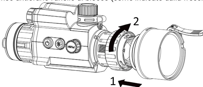
Figura 2-2 Installazione dell'adattatore
