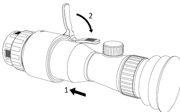
Figura 2-3 Installazione del mirino per luce diurna
