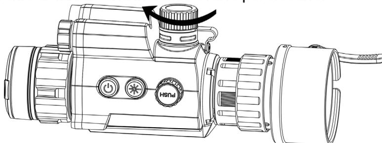
Figura 2-6 Chiusura del coperchio della batteria
