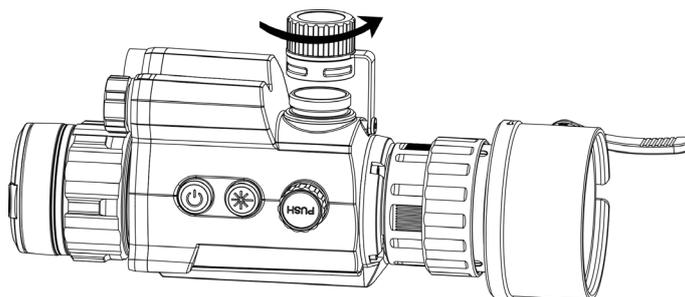
**Figura 2-4 Apertura del coperchio del vano batteria**
