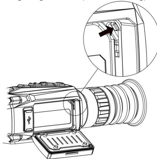
Abbildung 2-3 Entriegeln der Batterieverriegelung
