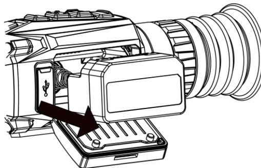
Abbildung 2-4 Einlegen der Batterie
