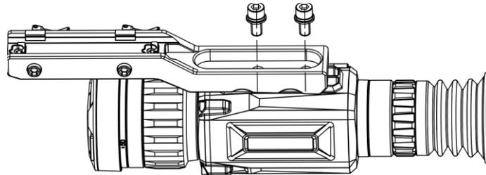
Abbildung 2-5 Schrauben einsetzen
