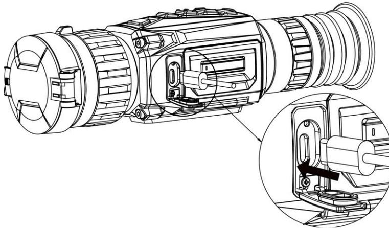
Abbildung 2-1 Kabelanschluss
