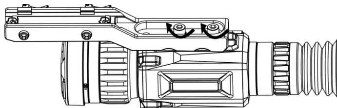
Abbildung 2-6 Gerät anschrauben
