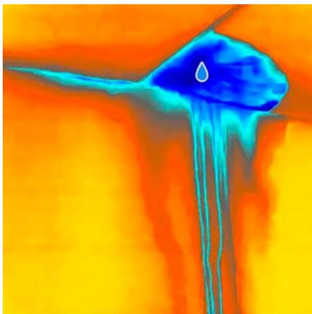
Pour inspecter les fuites d'eau des plafonds, des murs et des planchers des bâtiments à l'intérieur.
