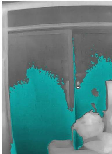
Este modo es para que los usuarios profesionales detecten anomalías en el aislamiento interior de paredes y techos de edificios. Los parámetros adicionales como **Temp. interior**, **Temp. exterior** y **Nivel de aislamiento**.
