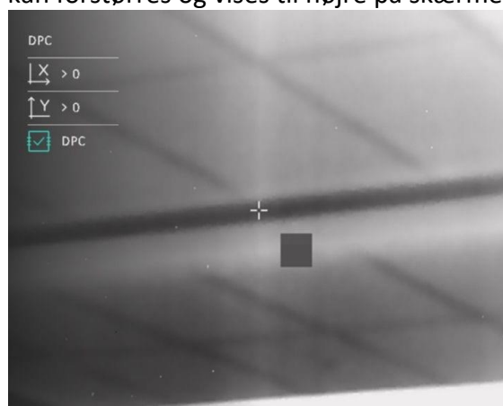
Figur 3-6 Korrektion af defekt pixel
