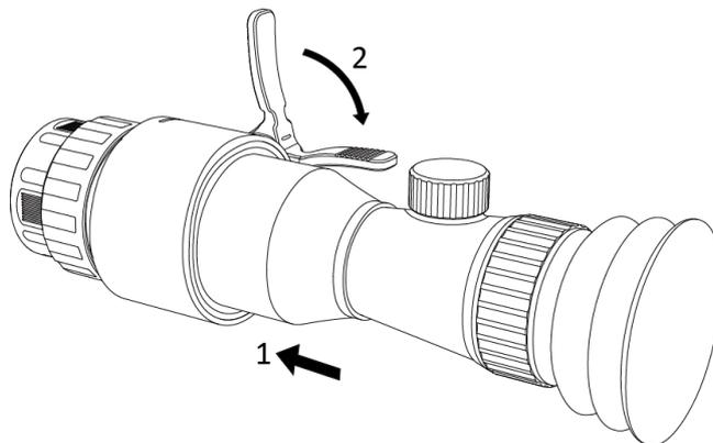
Figura 2-6 Instalación de la mira telescópica diurna
