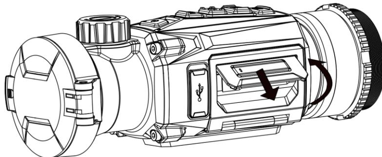
Figura 2-1 Retirar la tapa del compartimiento para las pilas
