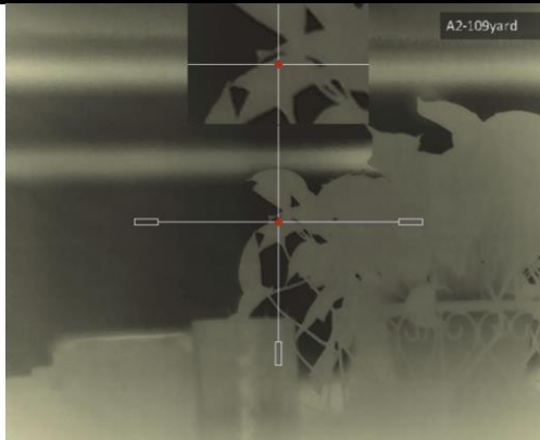
Abbildung 4-3 BiB-Effekt im Fadenkreuzmodus
