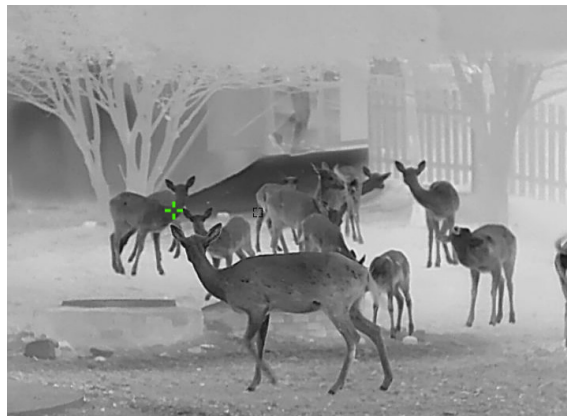
Figure 5-2 Suivi de point chaud
