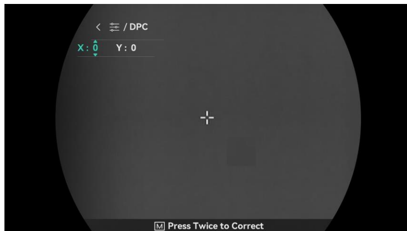
Figura 3-6 Corectarea pixelului defect
