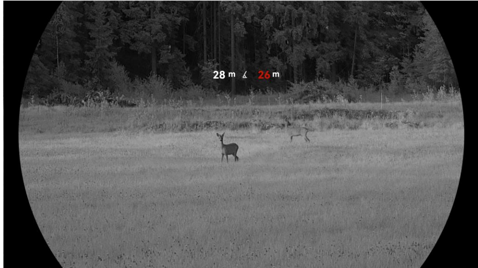
Figure 4-1 Résultat de la télémétrie laser
