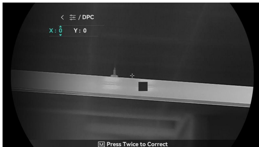
Figure 3-5 Correction de pixel défectueux
