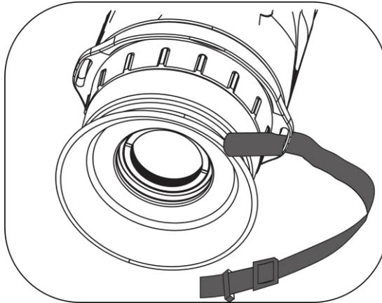
Figure 2-5 Enfilage de la sangle de cou dans les points de fixation
