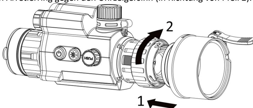
Abbildung 2-2 Adapter montieren
