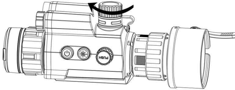
Abbildung 2-5 Batterieabdeckung schließen
