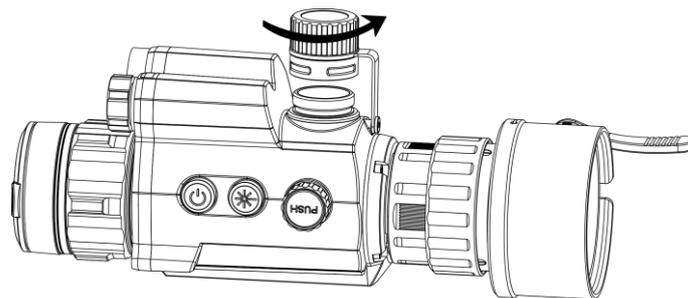
**Abbildung 2-3 Batterieabdeckung öffnen**
