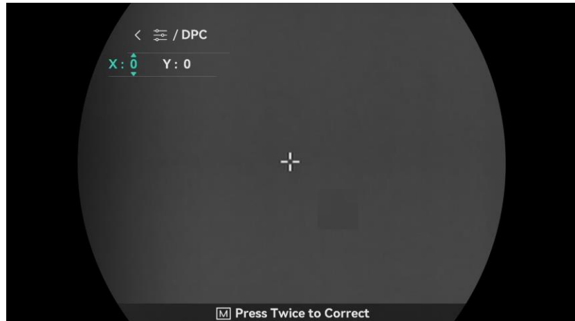
Şekil 3-6 Kusurlu Pikseli Düzeltilme
