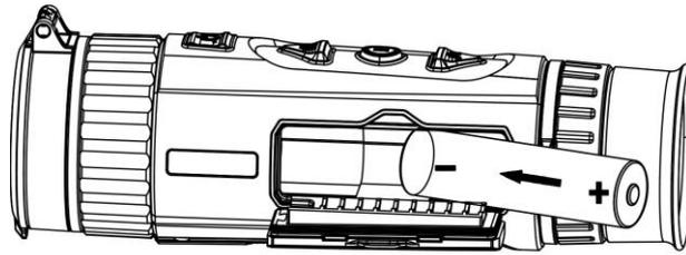
Figure 2-3 Installation de la batterie
