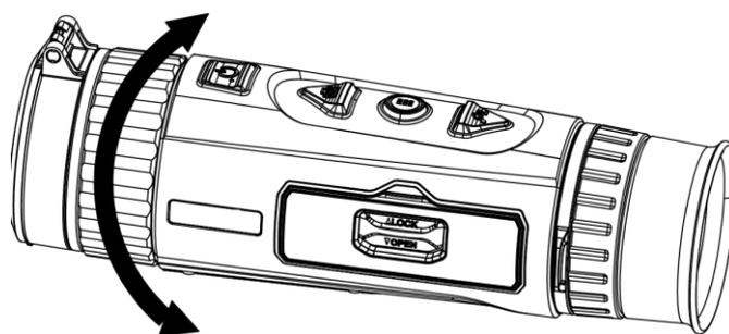
Figure 3-2 Réglage de la mise au point
