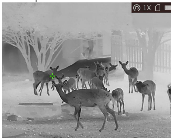
Figure 5-3 Suivi de point chaud
