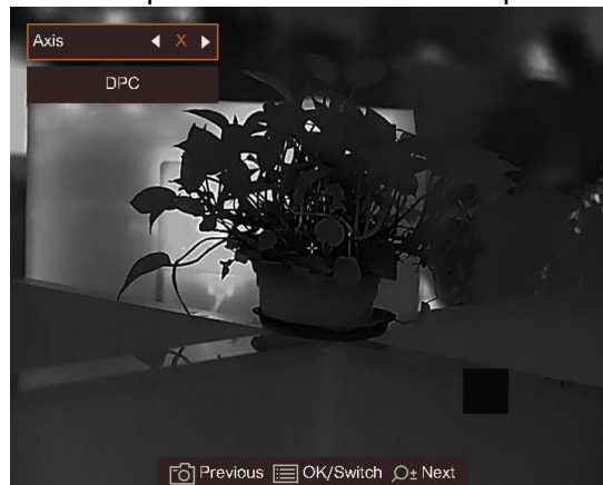
Figure 3-6 Correction de pixel défectueux
