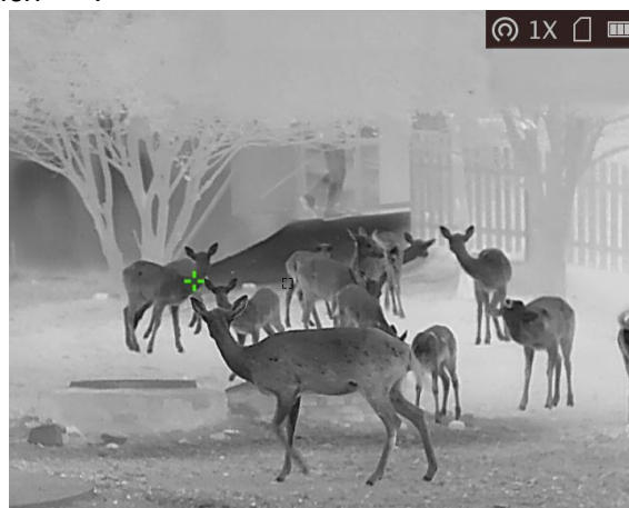
Abbildung 5-3 Stelle mit höchster Temperatur verfolgen
