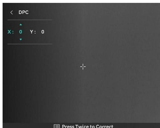
Figura 3-5 Correzione dei pixel difettosi
