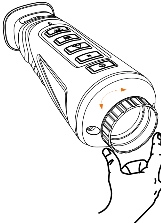
Figura 3-3 Ajustar la lente del objetivo
