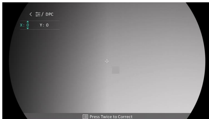
Figur 3-5 Korrektion af defekt pixel
