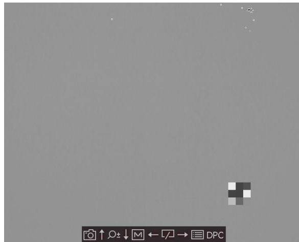
Figura 3-2 Corrección de píxeles defectuosos
