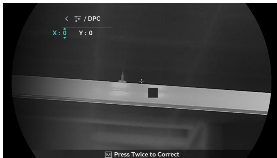
Obrázek 3-5 Oprava chybného pixelu
