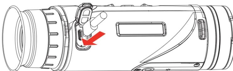
Figura 2-4 Connessione USB
