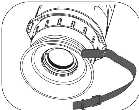
Figura 2-5 Inserimento della tracolla nel punto di attacco
