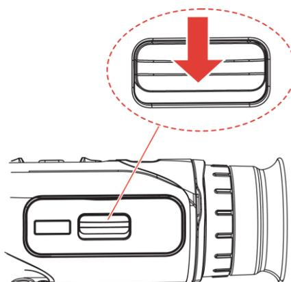
Figura 2-1 Aprire il coperchio del vano batteria
