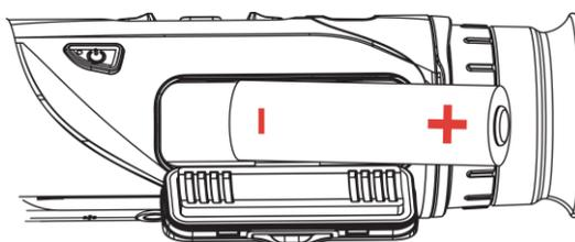
Figura 2-2 Inserimento della batteria
