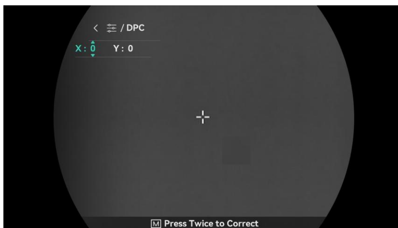
Фигура 3-5 Корекция на дефектни пиксели
