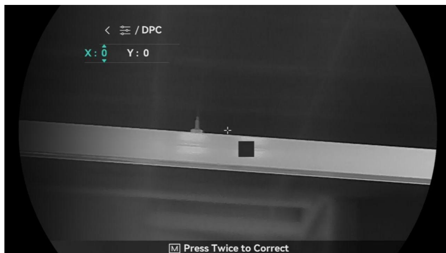
Figura 3-5 Corrección de píxeles defectuosos
