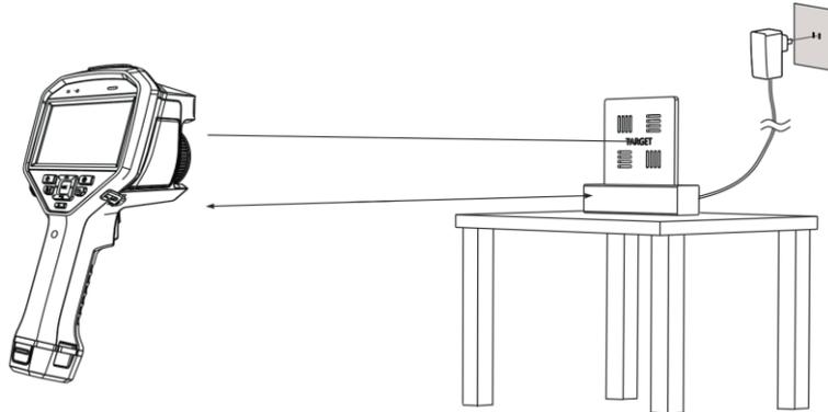
**Figura 2-10 Aponte para a placa de alvo**
