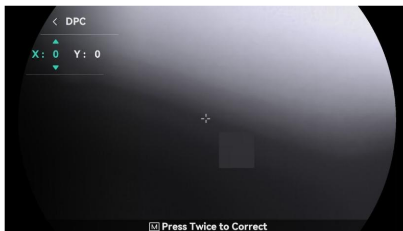
3-5. ábra: Hibás képpontok kijavítása
