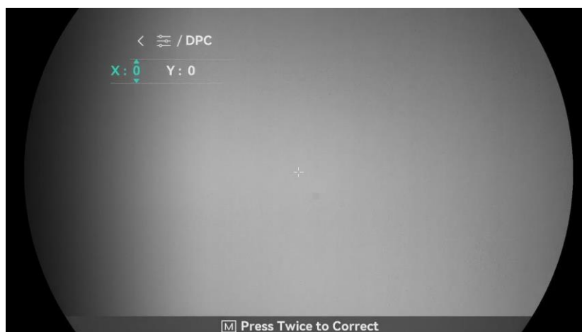
Figura 3-5 Corrección de píxeles defectuosos
