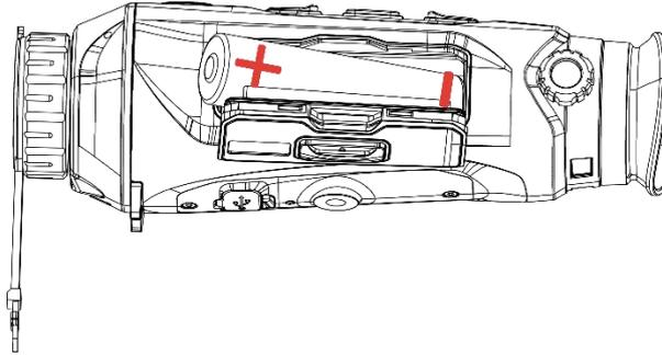
Abbildung 2-2 Die Batterie einlegen
