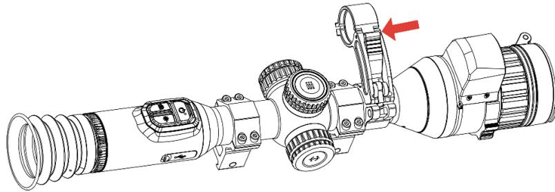
Figura 2-11 Bloquear la palanca
