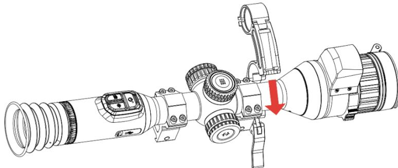
Figura 2-10 Abrir el soporte del iluminador IR
