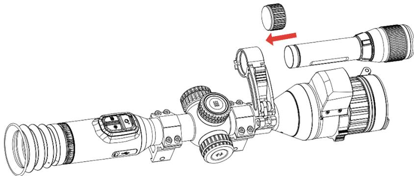
Figura 2-12 Colocar el iluminador IR en el soporte
