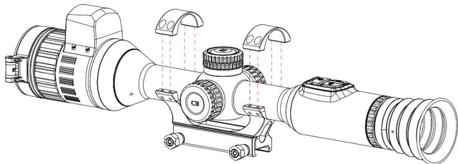
Figura 2-6 Colocar el dispositivo en el anillo
