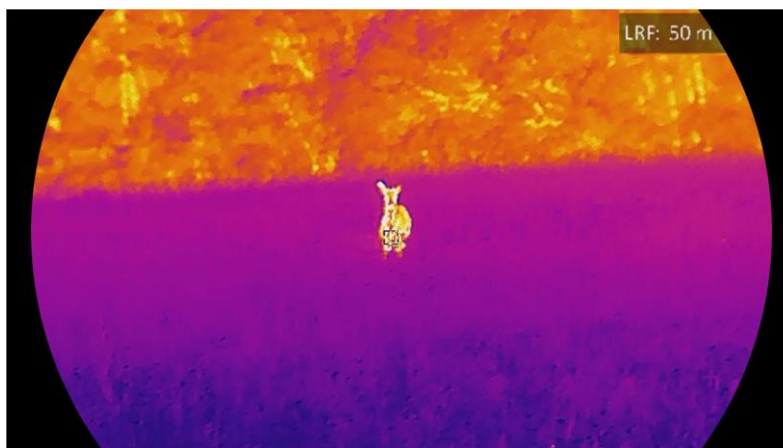
Obrázok 4-1 Výsledok merania vzdialenosti laserom
