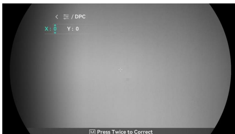
Obrázok 3-6 Korekcia chybných pixelov
