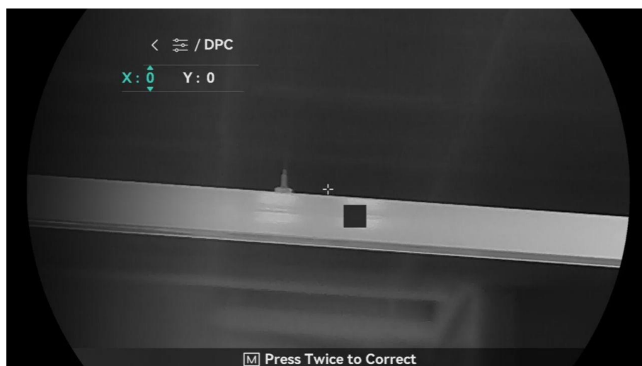
Figure 3-6 Correction de pixel défectueux
