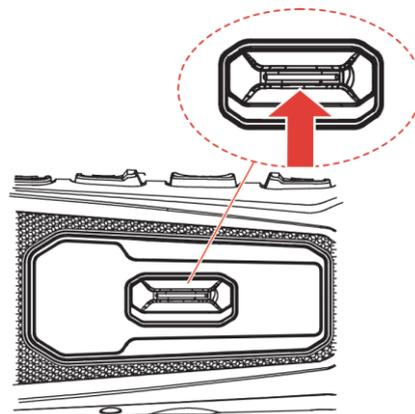
Figura 2-3 Fecho da tampa do compartimento da bateria
