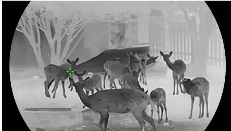
Kuva 5-1 Korkean lämpötilan seuranta
