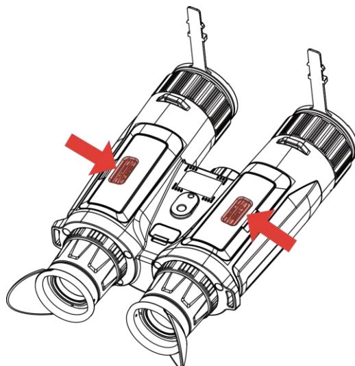
Рисунок 2-1 Відкриття кришки
