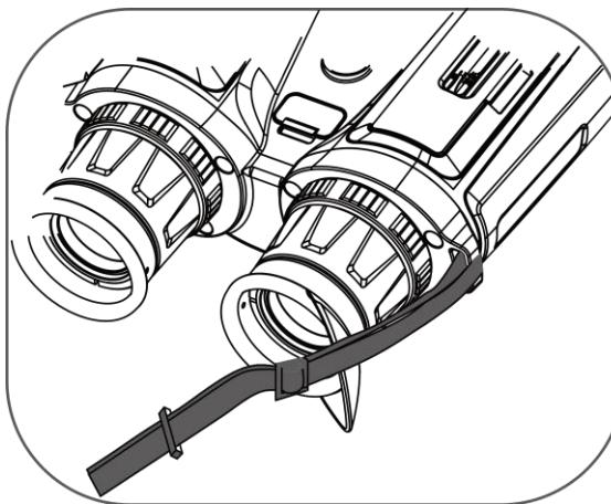
Рисунок 2-7 Протягування шийного ремінця через тримач ремінця
