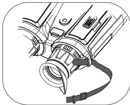
Рисунок 2-5 Протягування шийного ремінця через точку кріплення
