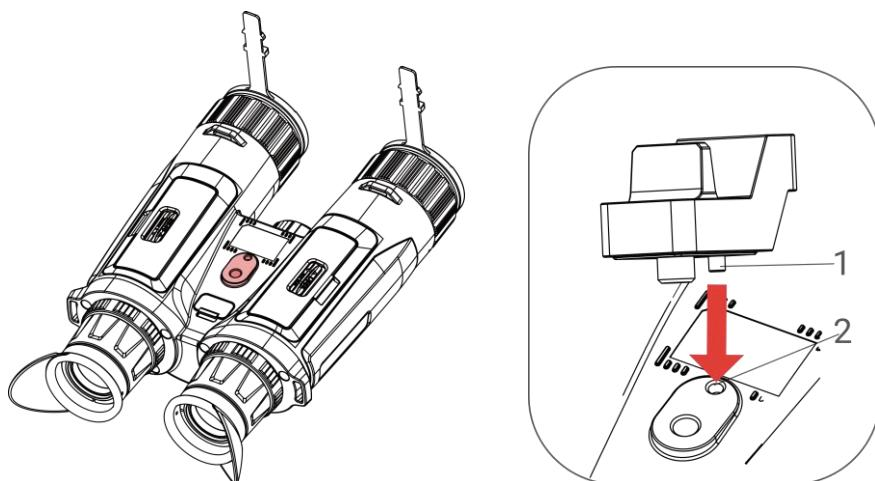
Рисунок 2-8 Вставка фіксатора
