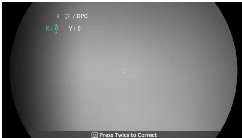
Фигура 3-5 Корекция на дефектни пиксели
