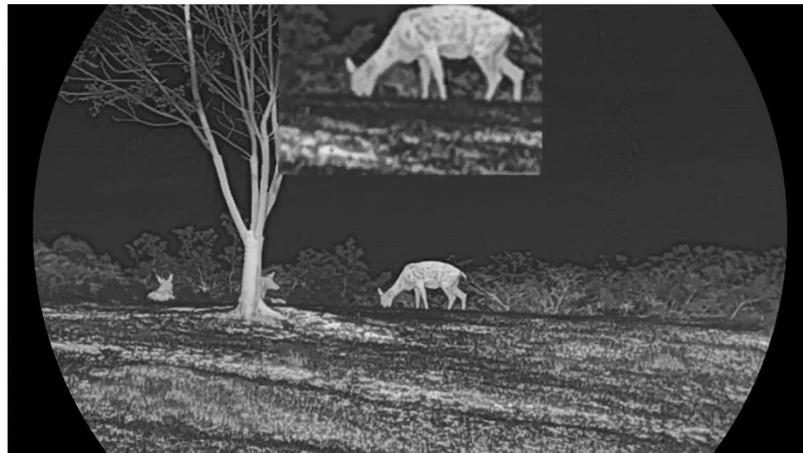
Figure 3-5 Réglage du mode PiP
