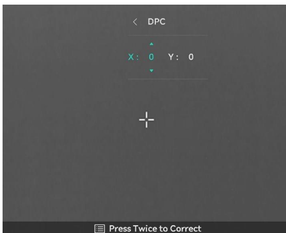
Obrázok 3-4 Korekcia chybných pixelov
