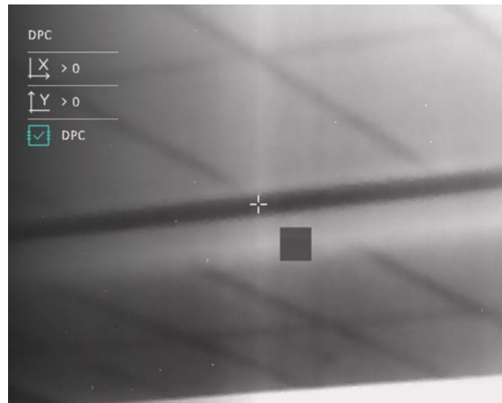
Abbildung 3-6 Defekte Pixel korrigieren
