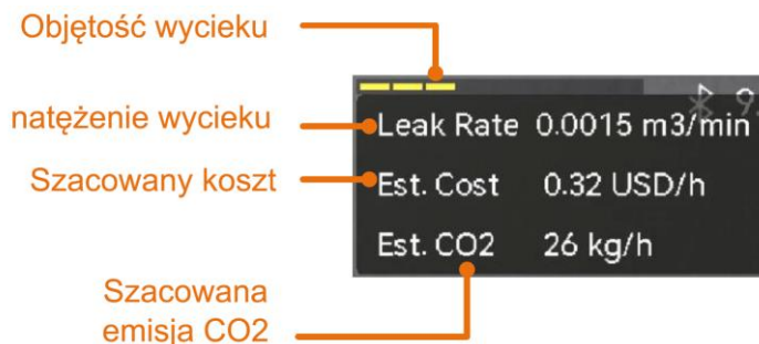
Rysunek 4-2 Szacowanie wycieku gazu (skompresowane powietrze)
