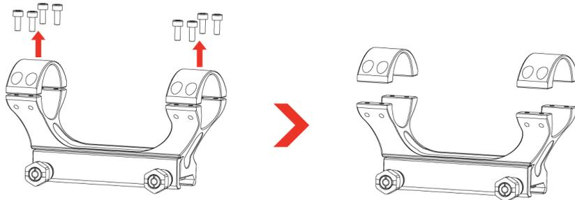
Abbildung 2-5 Schrauben Sie den oberen Ring auf
