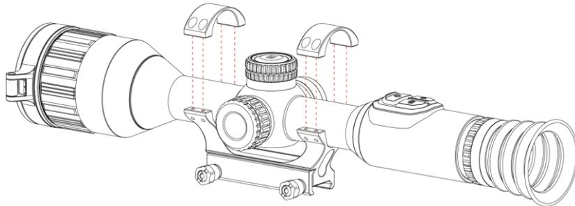
Abbildung 2-6 Legen Sie das Gerät in den Ring
