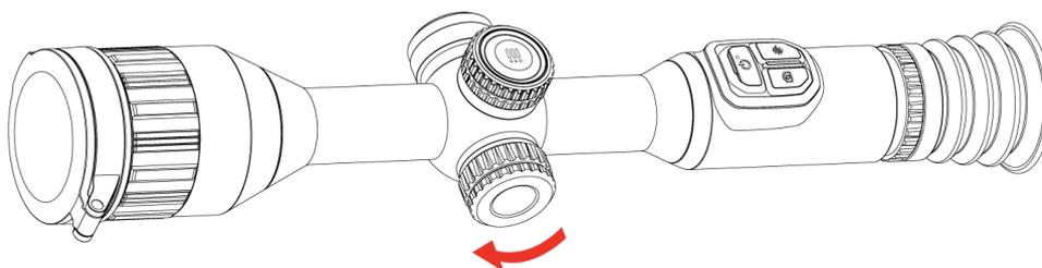
Abbildung 2-4 Abdeckung festziehen
