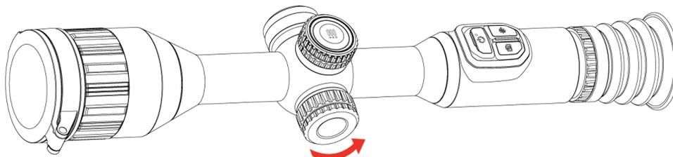
Abbildung 2-2 Abdeckung lösen
