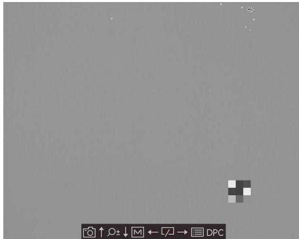
**Figura 3-2 Corrección de píxeles defectuosos**
