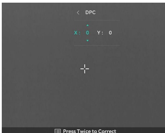
Figura 3-4 Correzione dei pixel difettosi
