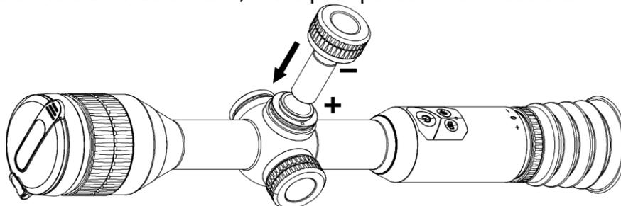
Figura 2-3 Installare la batteria
