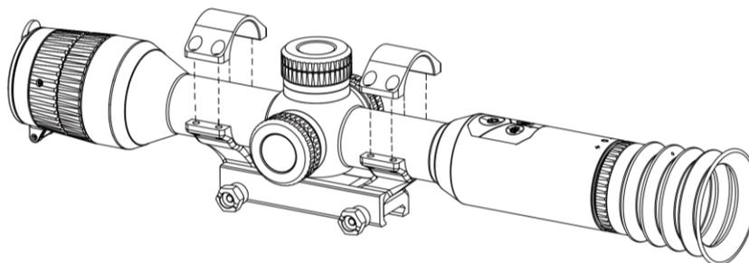
Figura 2-6 Installazione del dispositivo nell'anello
