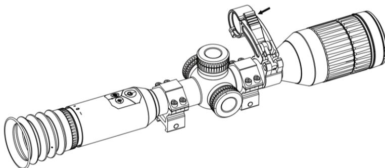
Figura 2-11 Blocco della leva
