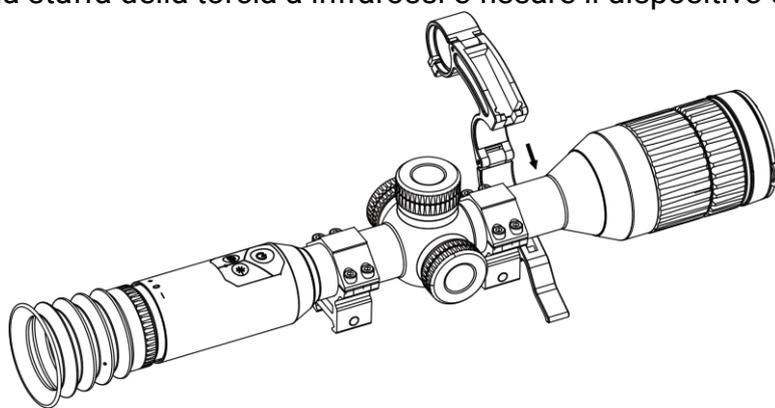
Figura 2-10 Apertura della staffa della torcia a infrarossi
