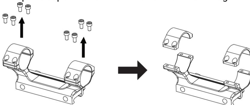
Figura 2-5 Rimozione dell'anello superiore
