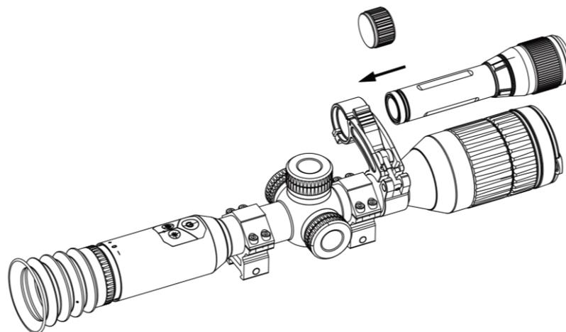
Figura 2-12 Inserimento della torcia a infrarossi
