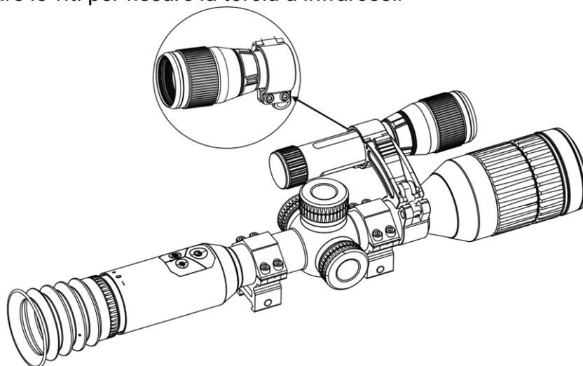
Figura 2-13 Fissaggio della torcia a infrarossi
