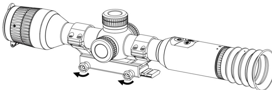
Figura 2-9 Serraggio delle viti
