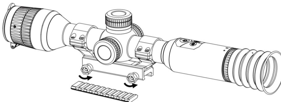
Figura 2-8 Allentamento delle viti
