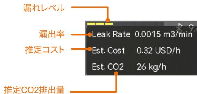
図 4-2 ガス漏れの推定（圧縮空気）
