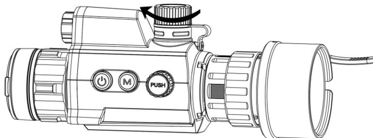
Figura 2-5 Fechar a tampa do compartimento da pilha
