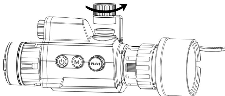
Figura 2-3 Abrir a tampa do compartimento da pilha
