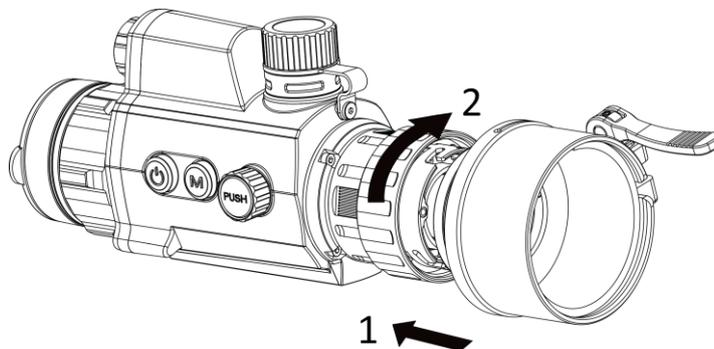
Figura 2-2 Instalar o adaptador
