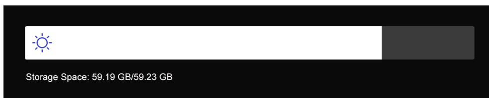
Obrázek 3-2 Nastavení jasu pomocí nabídky zobrazené po přjetí dolů
