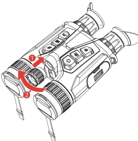
Figura 2-8 Montaggio dell'illuminatore
