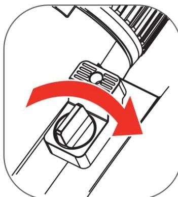
Figura 2-14 Rotazione della vite
