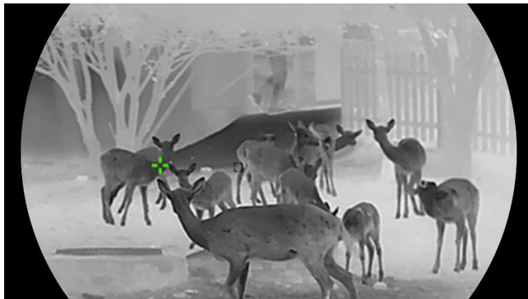
Figure 6-2 Suivi de point chaud
